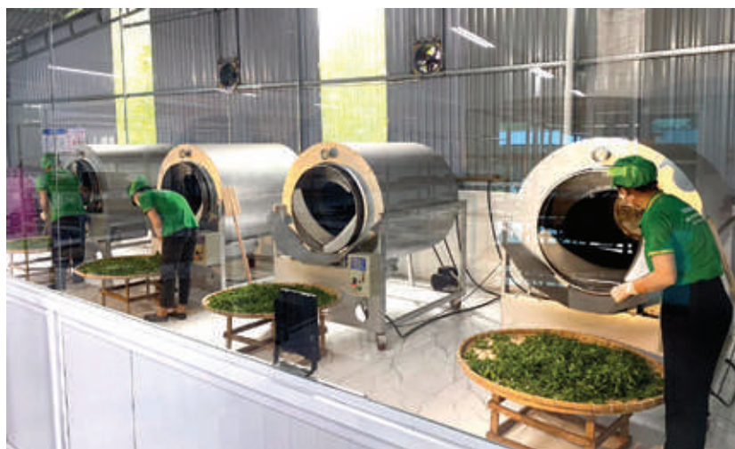
Đề án khuyến công đã hỗ trợ máy sao chè bằng gas cho một số hợp tác xã sản xuất, kinh doanh chè
