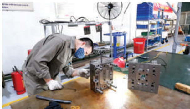
Một công đoạn lắp ráp và kiểm tra khuôn dập của Automech
