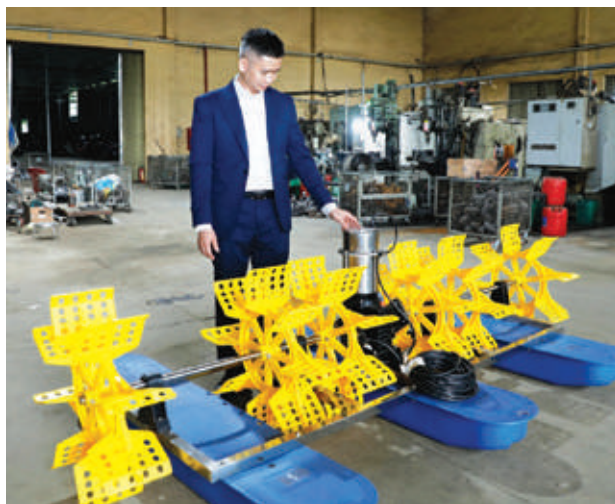
Máy guồng tạo oxy cho tôm, cá do Công ty Cổ phần Điện cơ Thiên Long HP chế tạo
