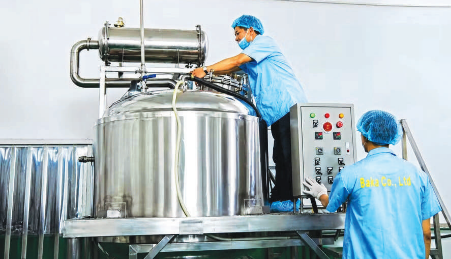
Công ty TNHH BaKa đầu tư hệ thống máy trích ly và cô đặc chân không phục vụ sản xuất cà phê hòa tan
